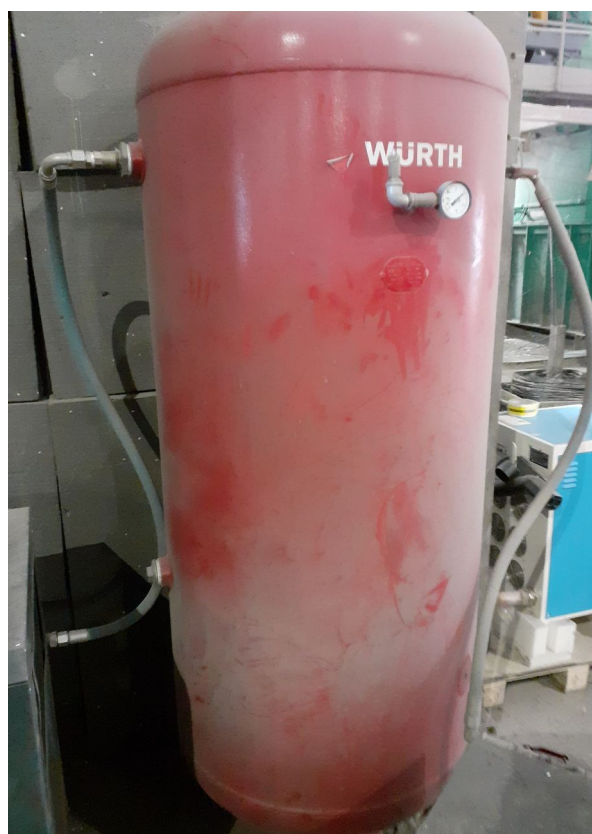
Compresseur soumis à la réglementation ESP
